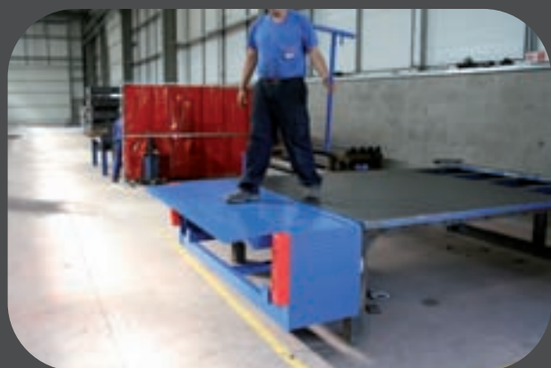
El muelle nivelador es ideal para carga y descarga
